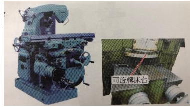
圖 3、左圖為萬能銑床[1]；右圖為可調整的角度的床臺機構。
