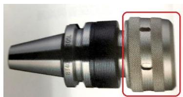
圖 14、銑床常用刀把(刀軸+夾頭)[1]；其中紅框部分即為夾頭，配合錐度筒夾使用，並利用鉤形扳手對準夾頭上的溝槽轉動以收縮筒夾孔徑逼緊銑刀柄進而夾緊銑刀。
