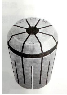
圖 15、銑床常見之錐度筒夾[1]；中間圓形孔即為銑刀柄放入處。
