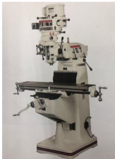
圖 5、砲塔式銑床[1]；本系實習工場的機型即為砲塔式銑床。
